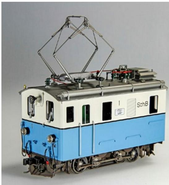
Die Lok Nr. 1 zeigt die Dachaufbauten nach dem Wechselstrombetrieb-Umbau. Dazu gehören auch modernere Stirnlampen und die kurze Anschrift SchB.
