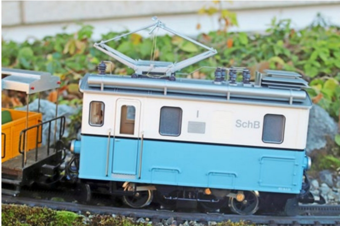
Die Seitenwände sind vorbildgetreu bedruckt mit Bahnlogo, Nummer, Revisionsdatum und Fabrikations-schild. Man beachte auch den heruntergebugenen Panto für vorbildgetreues Fahren ohne Fahrleitung.
