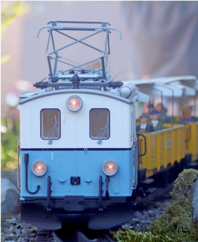
Stirnfront des Modelles mit feinen Scheibenwischern, Heizleitungskupplung, Bremschläuchen, Stirnlampen und der schwarzen LGB-Steckdose für die Wagenbeleuchtung.
