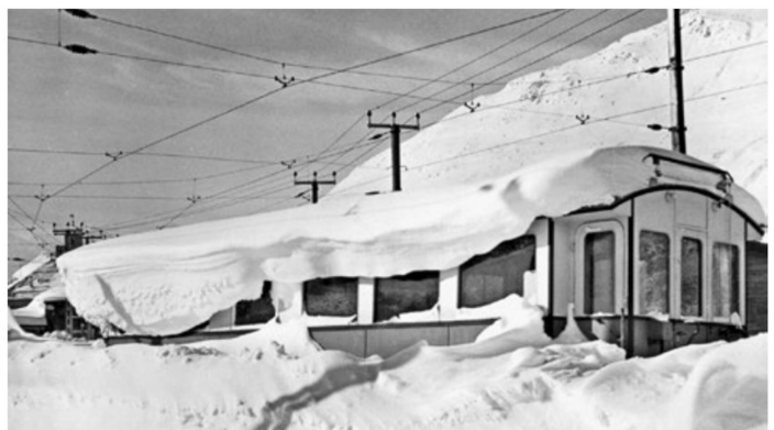
Postkarte aus den 1930er-Jahren, erkennbar ist die Dachrutenkupplung des Gleichstrombetriebs.
