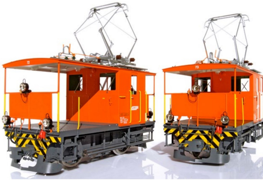
Ladefläche und Rangierplattform sind beim Te 2/2 72 (links) mit feinem Riffelblech belegt, und beim Te 2/2 73 (rechts) sind sie holzbeplankt.
