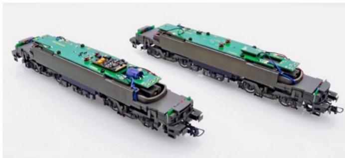
Das sauber aufgeräumte und vorbildliche Innenleben des Roco-Vectrons. Vorne ist die Modellausführung mit Sound, hinten die DC-Analoglokomotive mit dem Brückenstecker.
