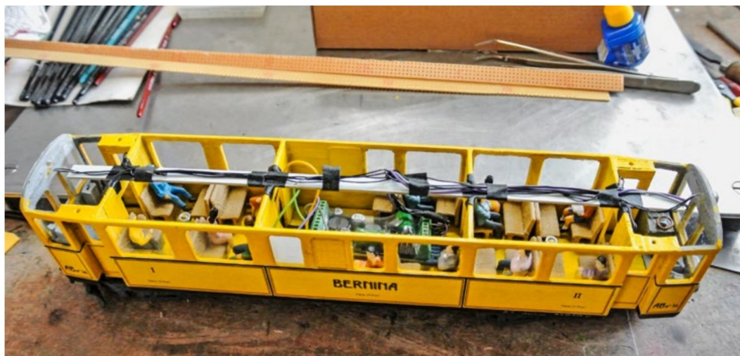
Ein Blick in den geöffneten Triebwagenkasten zeigt den Digitalbaustein in der Mitte und die Verdrahtung für die Front- und Innenbeleuchtung.
