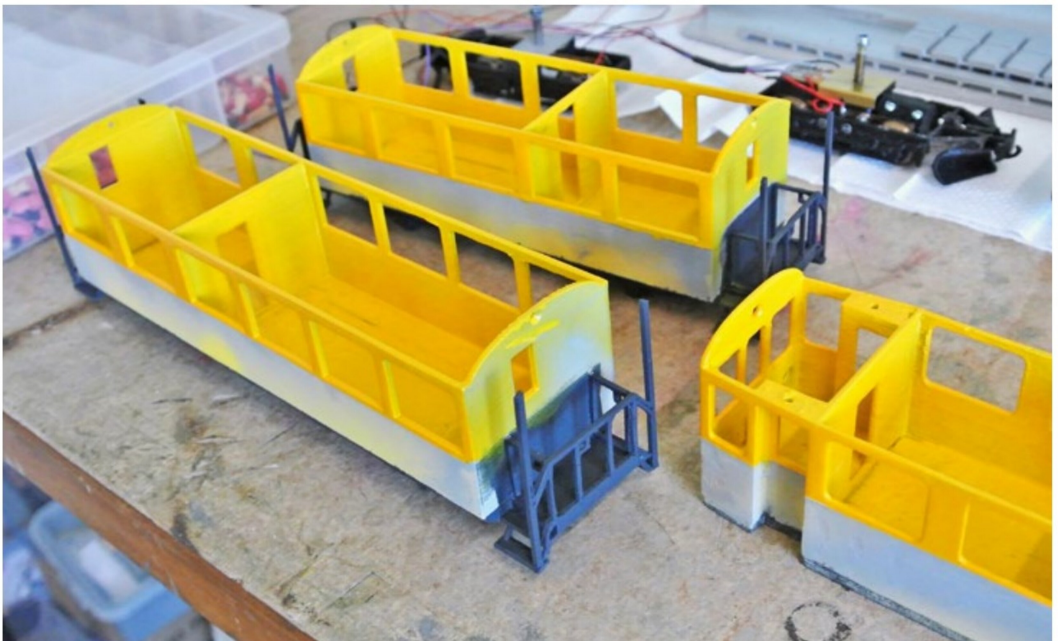
Die Rohgehäuse der geschlossenen Fahrzeuge sind ebenfalls fertig gespritzt. Auf den hellen Flächen wird die Beschriftung angebracht.
