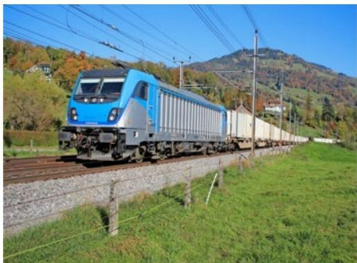
Die BR 187 001 und 003 sind neuerdings an das EVU railCare vermietet und ergänzen den bestehenden Lokpark. Mit diesen Last-Mile-Loks kann auf den Einsatz zusätzlicher Rangierdieselloks verzichtet werden.
