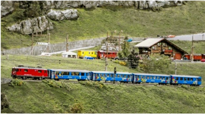
Ge 4/4 II , 1650 kW, 50 t, Last: 16 Achsen, 195 Plätze, 65 t, V/max 90 km/h.
