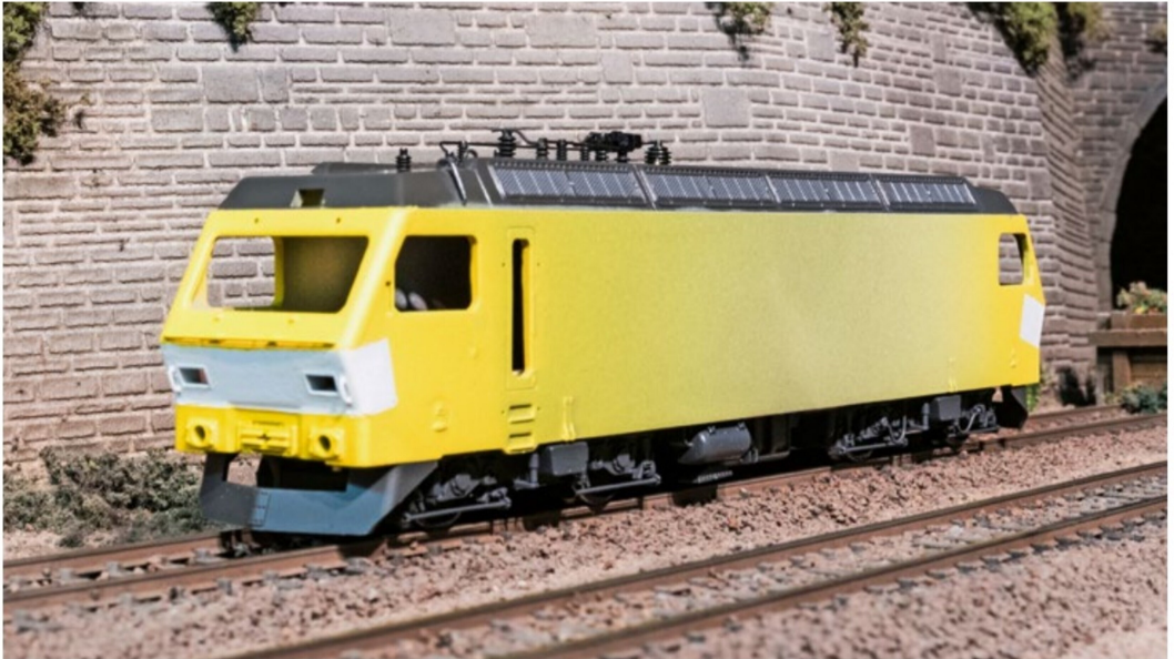
Sandstrahlen, grundieren und weiss spritzen. Danach den Teil abdecken, der weiss bleiben soll, und die Front hellgelb spritzen.
