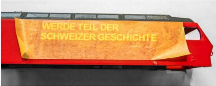
Die Beschriftung nimmt man mit einem Kontaktband von der Folie und überträgt sie auf die Lok.
