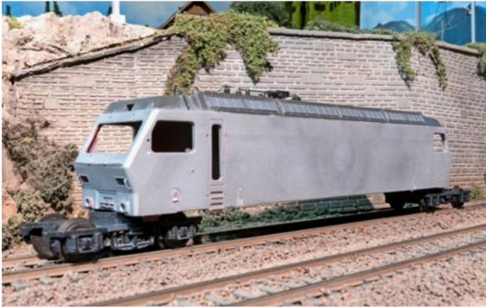
Da die HAG-Modelle aus Metall sind, kann man die alte Farbe nur mit Sandstrahlen entfernen.
