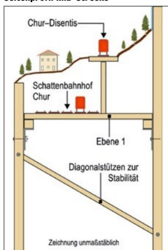
Die Gleise des Schattenbahnhofs Chur auf Ebene 1 befinden sich unter dem Gelände.
