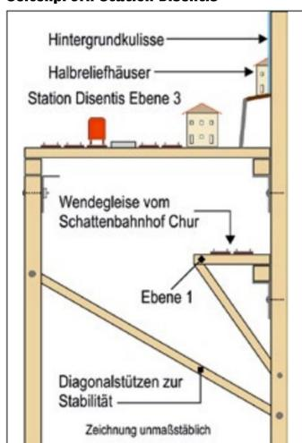
Die Gleise der RhB-Wendeschleife sind für eine sitzende Bedienung hinten positioniert.
