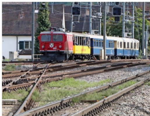
Bild mit sehr individuellem Touch: Zug mit unnötig gesenktem Bügel und 3 × Rot-Signalisierung an der Lok auf der Verbindung ChA–Stammnetz.
