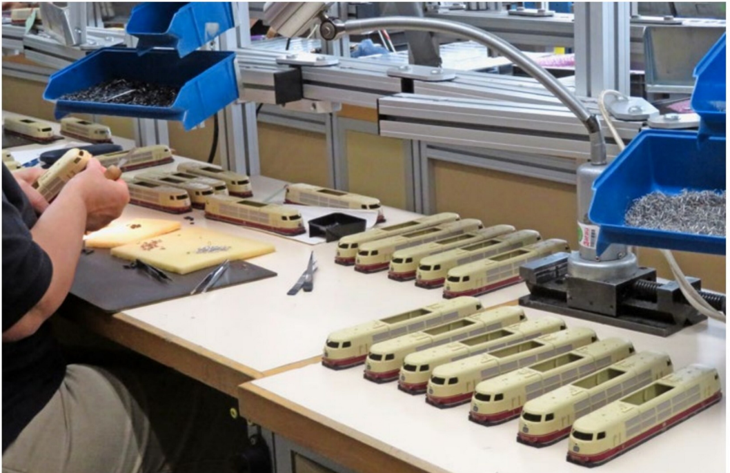
In der Lokmontage werden die zahlreichen Ansteckteile jeweils einzeln von Hand auf die Lokgehäuse gesetzt.
