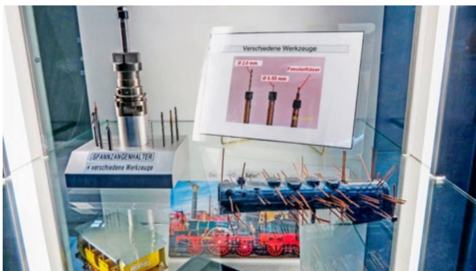
Für Anbauteile müssen an einem Dampflokkessel bis zu 130 Löcher gebohrt werden.
