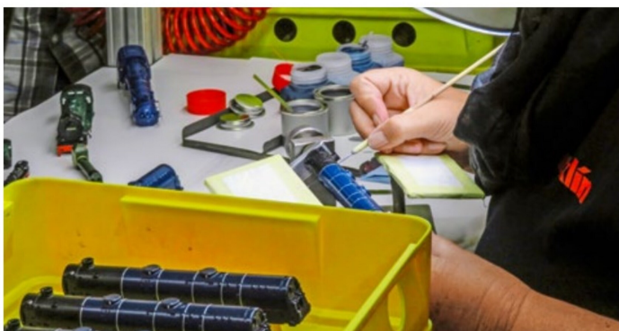
Grosse Handwerkskunst ist beim Bemalen der Dampflokkessel in der Handmalerei gefragt.
