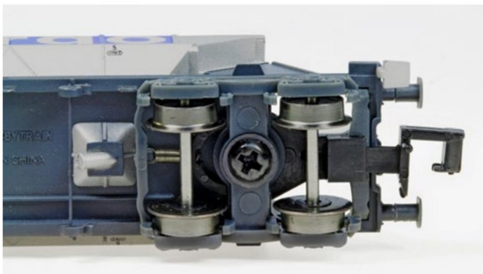
Zweckmässig simple Drehgestellbefestigung und Kurzkupplungsmechanik des Hobbytrain-N-Modells.
