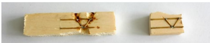
Wichtige Helfer: links die Lötlehre und rechts die Schleiflehre.
