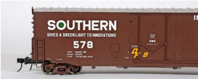
Feines Detail: Nachbildung der mit Druckluft zu verschliessenden seitlichen Türen, «plug-style doors».
