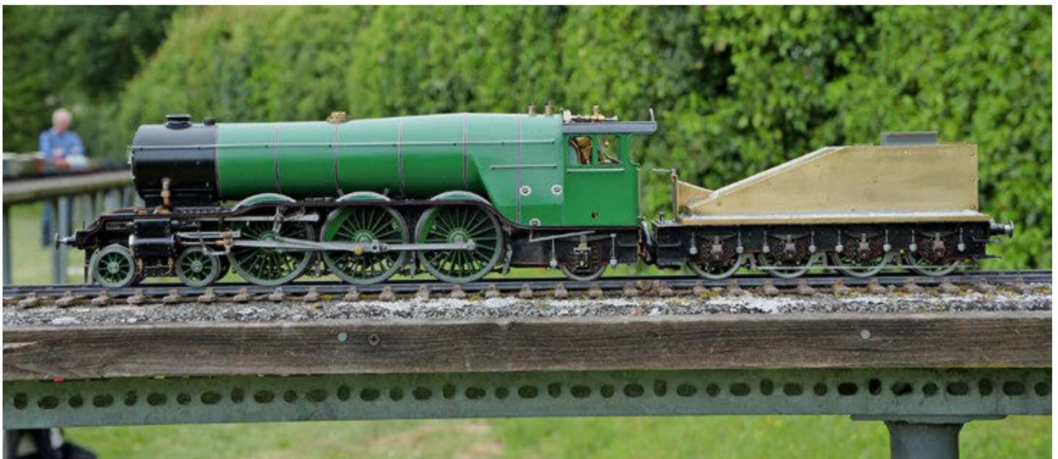
Diese englische Schnellzug-Dampflokomotive in Spur I mit vierachsigem Korridortender ist kohlegefeuert und im Eigenbau entstanden.
