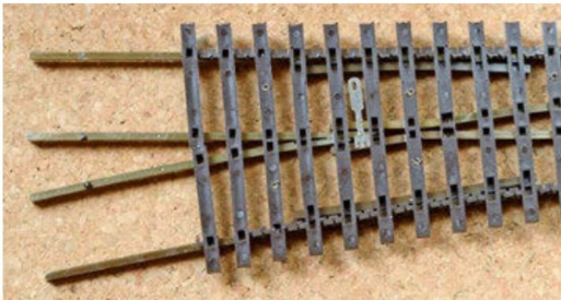
Bei einer Weiche, die zum nächsten Bahnhofsbrett führt, mussten die Gleise eine Kürzung über sich ergehen lassen.
