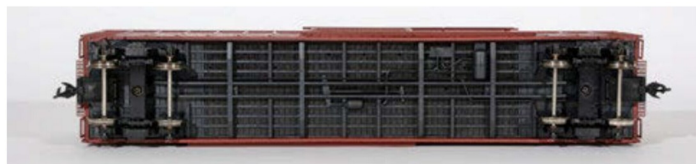
... einwandfrei ausgeführt. Die Drehgestelle haben in Metallbuchsen gelagerte Achsen erhalten.
