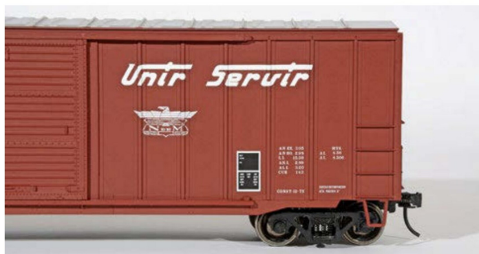
Die Anschriftenfelder, die «consolidated stencils», am NdeM-Boxcar sind sauber aufgedruckt und lesbar.
