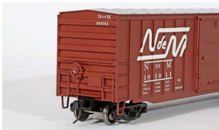
Die Stirnseite ist mit einem Bremsrad nach heutigem Standard ausgestattet. Die Lackierung ist ...
