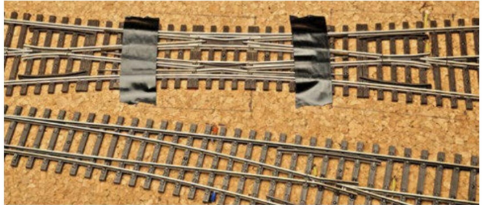
Vor dem Wenden der Weichenstrasse zum Montieren der Weichenantriebe sind bei den Roco-Weichen die Zungen durch ein Klebeband zu sichern.
