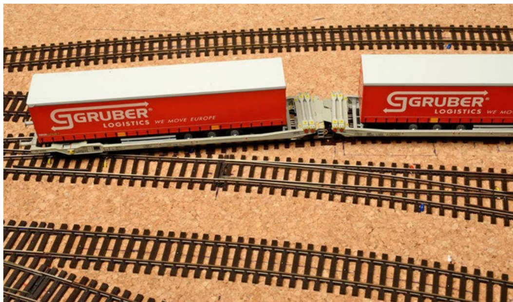
Ein Beispiel für den Einsatz von längeren Fahrzeugen der Epochen V und VI auf dem Weg von den Gütergleisen über die RocoLine-DKW und die auf 10° angepasste Weiche von Tillig-Elite zur Ausfahrt in eine der beiden Richtungen. Im Bild ein Doppeltaschen-Tragwagen vom Typ Sdggmrs von Rocky-Rail. Den Wagenversatz auf diesem Fahrweg kann man als optimal für Modellbahnen bezeichnen.
