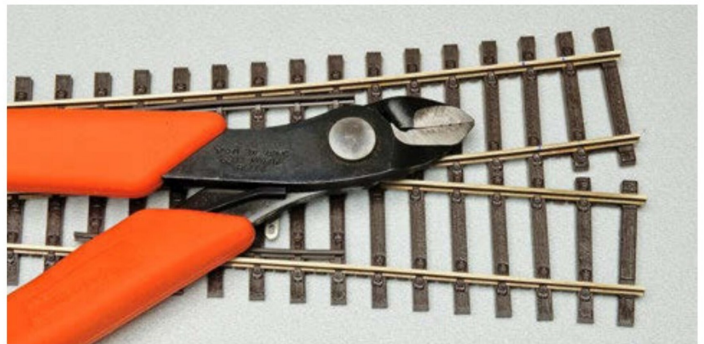
Mit dem Gleisschneider der Marke Xuron wird das Kürzen des ablenkenden Strangs vollzogen. Der Schnitt muss mit der glatten Wate ausgeführt werden.
