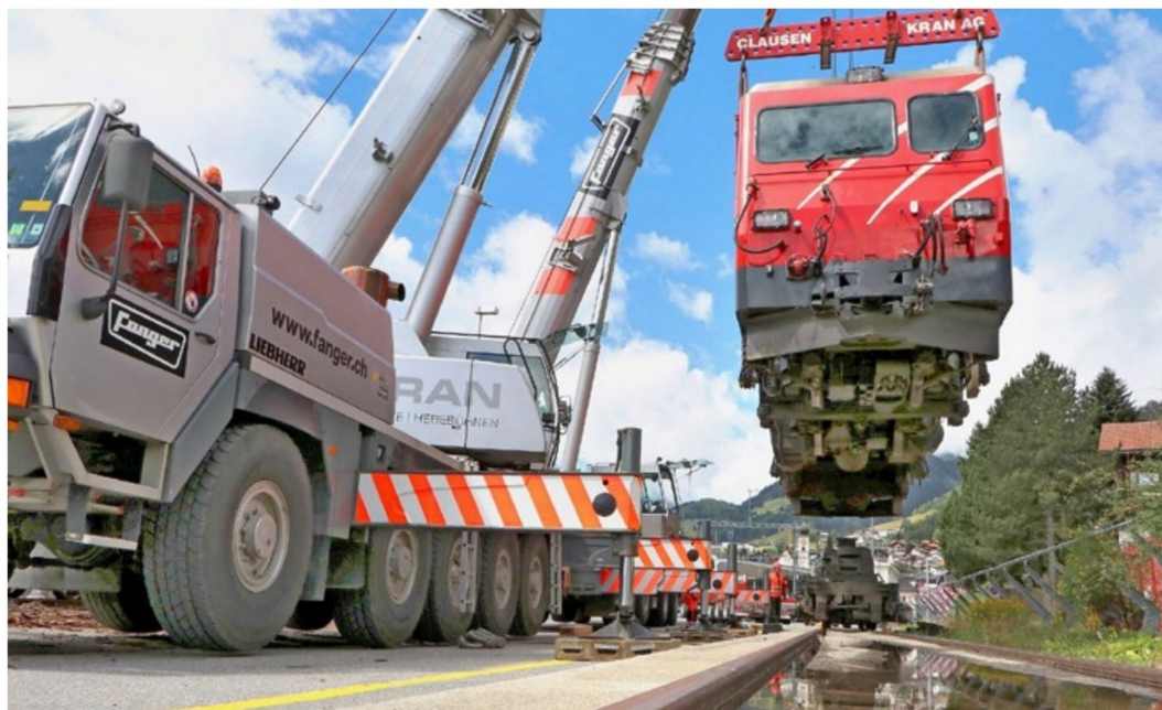
Die Lok wird so weit hochgehoben, damit sich das Ersatzdrehgestell richtig positionieren lässt, und im Anschluss wieder abgesetzt.
