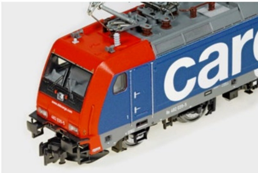
Werkseitig ist das Modell mit der Fleischmann-«Profilkupplung» ausgerüstet.
