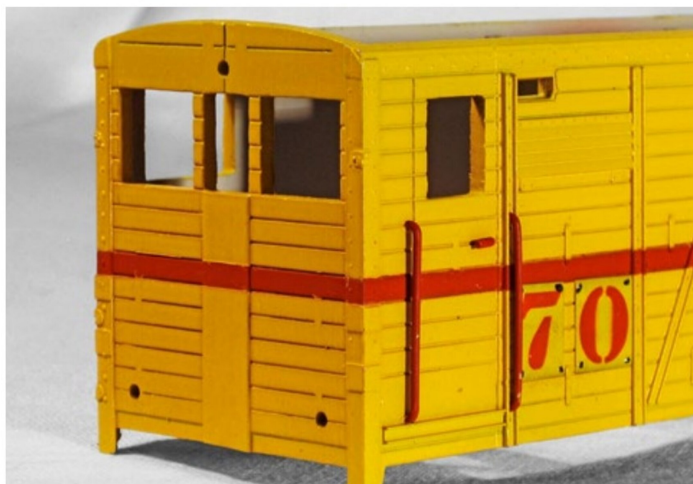
Detailansicht der Triebwagenfront mit den Fensteröffnungen, Lampenbohrungen und der Einstiegstüre.
