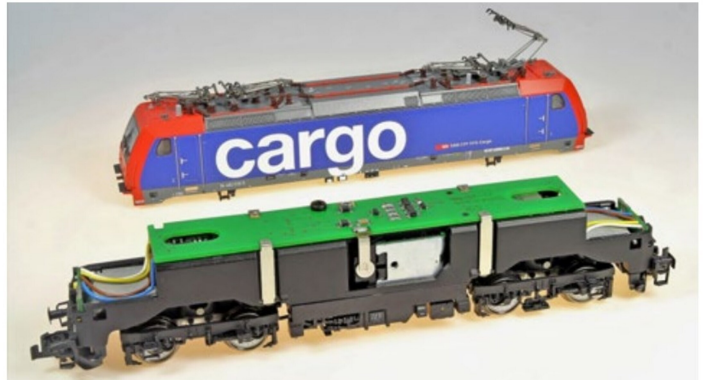
Auch ohne das Gehäuse sauber, aufgeräumt und attraktiv: die neue Technik der N-Maschine.
