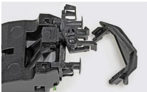
Der nur eingesteckte Schienenräumer macht sich gerne selbstständig.
