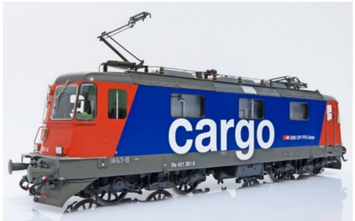
... steht nur ein Stromabnehmer zur Verfügung, für den Einsatz in Deutschland ist der WBL85 montiert.
