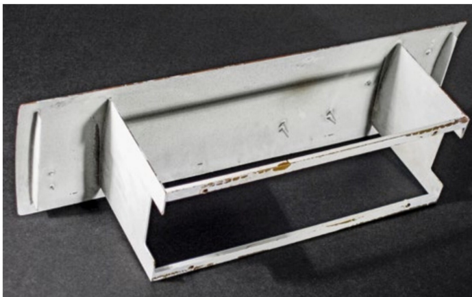
Das Dach wird zusammen mit den Führerstandsrückwänden als ein komplettes Teil gefertigt.
