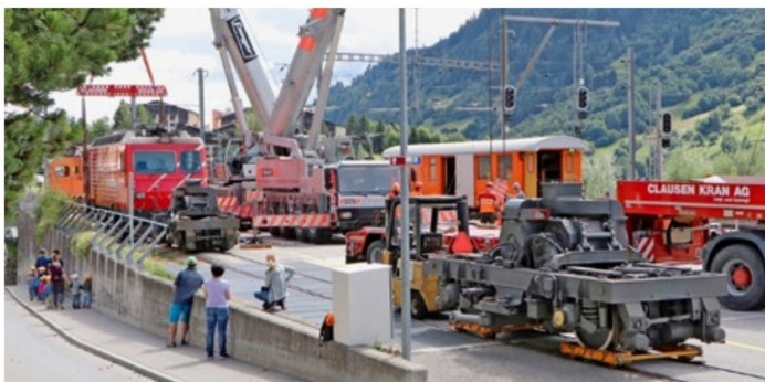
Zwischenphase beim Drehgestellwechsel. Im Vordergrund die defekte Einheit auf Diplorys.
