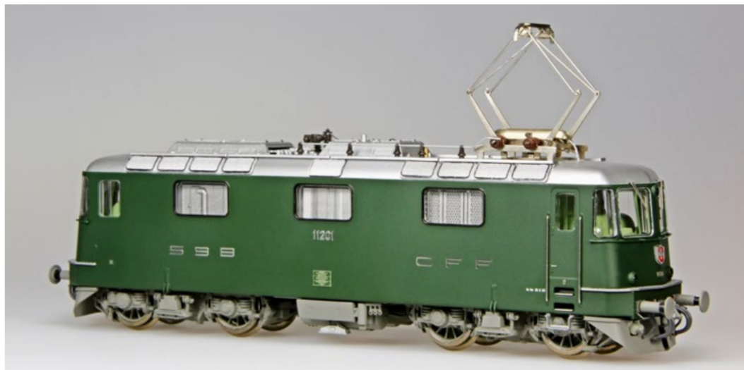
Die fertig umgebaute Re 4/4 11201 auf einen Blick. Der Vergleich mit dem Vorbildfoto zeigt die Stimmigkeit mit dem Umbaumodell.
