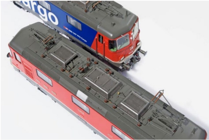
Fein detaillierte Dachpartie inklusive der Verbindung vom Hauptschalter zur Hochspannungsdachleitung.
