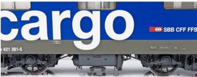
Die Re 421 381 weist vorbildrichtig einen geänderten Zugsicherungsmagnet auf.
