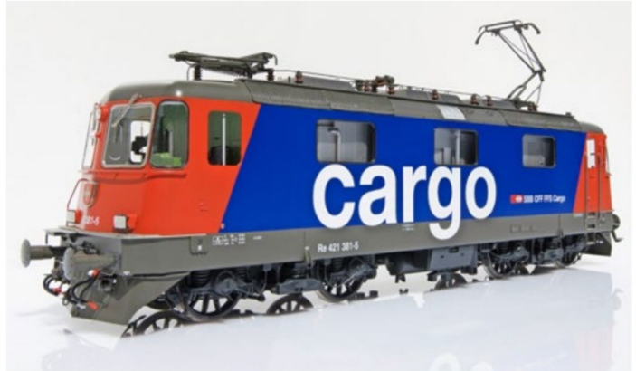
Die Re 421 381 hat unterschiedliche Pantografen für den grenzüberschreitenden Verkehr. In der Schweiz ...
