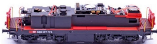
..., als auch mit den Bausteinen für die Soundelektronik.
