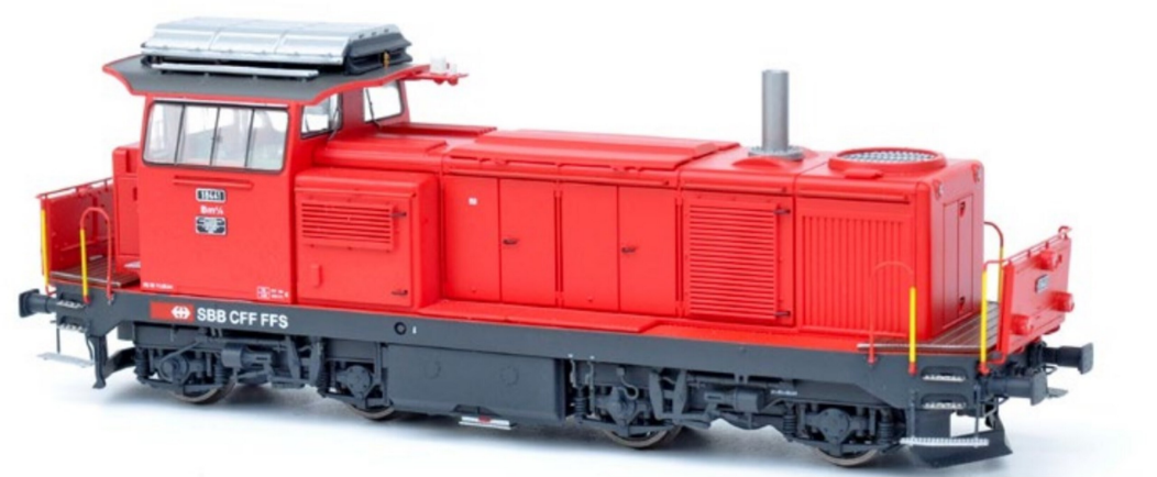
Bei der Bm 4/4 18441 sind deutlich die Riffelblechabdeckungen auf den Plattformen und die farblich abgesetzten Details wie Türgriffe sichtbar.
