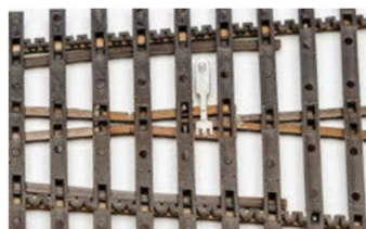
Vor dem Anlöten der Leitungen ist die Brünierung an den Profilen zu entfernen.
