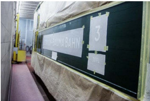
Die Beschriftung wurde durch eine Schriftschablone auflackiert und ...
