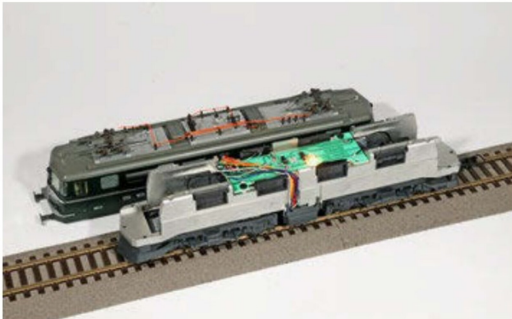
Antiquierte Beleuchtungstechnik mit zwei Birnchen auf der Platine.
