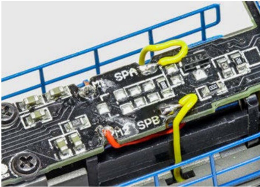
Die gelben Lautsprecherkabel sind hier hoch zur Hauptplatine geführt.
