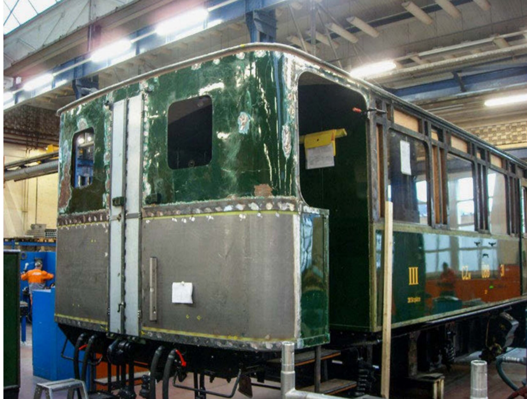
Nach stellenweisen Schlosserarbeiten am Wagenkasten musste die gesamte Aussenhaut gründlich ausgespachtelt und abgeschliffen werden.
