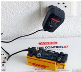
Vor den ersten Fahrversuchen muss der fest im Lastwagen eingebaute Akku geladen werden.
