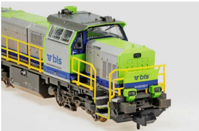
Die andere Seite ist mit einer N-Standardkupplung versehen, die in einer Aufnahme nach NEM steckt.
