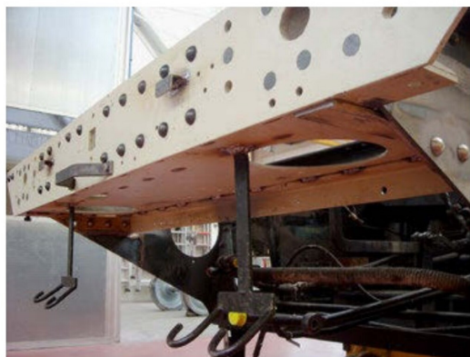
Durch die Stauchung mussten viele Teile am Rahmen ersetzt werden, was ...
