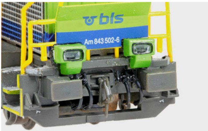
Eine Lokseite ist mit Nachbildungen von Kupplungshaken und Verbindungsschläuchen ausgerüstet.
