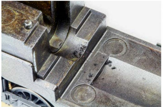
... der Betriebsstunden nimmt auch die Menge dieses Kohlestaubes ...
