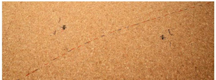
Die Korkplatten weisen eine plan geschliffene Seite auf, auf denen die Gleise fixiert werden. Durch die unterhalb verlaufende Trasse im Bogen wird zuerst die Elite-DKW verlegt.
