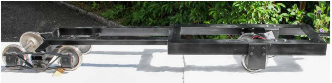
Das Herzstück – der Rahmen mit dem vorderen Drehgestell und der eingebauten Antriebseinheit, vorbereitet für die ersten Rollversuche.
