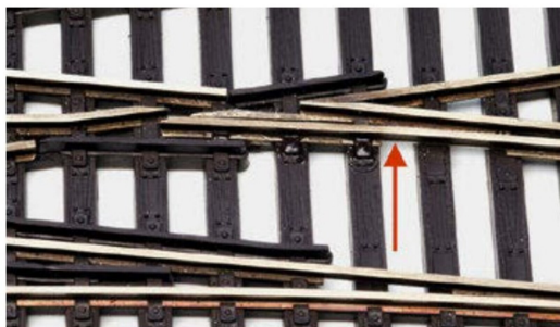
An der rot markierten Stelle erfolgte der Zungenanschluss, da hier eine kaum wahrnehmbare Verschiebung beim Umstellen auftritt.
