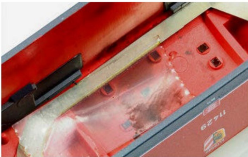
... erheblich zu. Im Extremfall droht der «decoderkillende» Kurzschluss!
