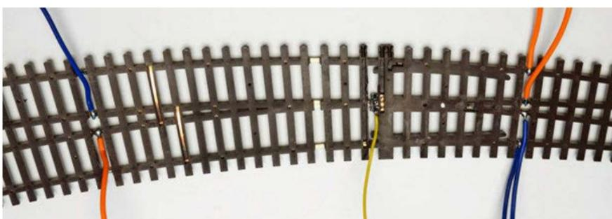
Für eine absolut sichere Fahrstromversorgung sind alle Schienenteile der Bogenweiche, inklusive des Herzstücks, mit Anschlussleitungen ausgestattet. Die Strombrücke beim Herzstück erstreckt sich über drei Schienenteile.
