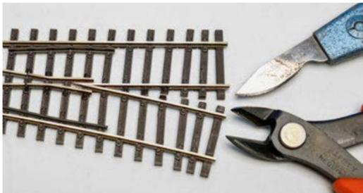
Zur Begradiung des abzweigenden Strangs einer geraden Elite-Weiche ist das zusammenhängende Schwellenband im Bogenbereich mit einem Messer oder einem Seitenschneider aufzutrennen.
