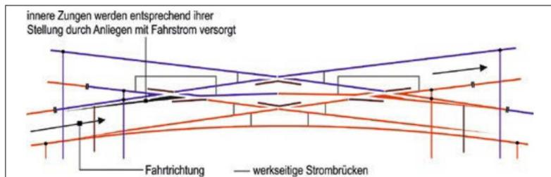
Bei der Elite EKW II, Bauart Baeseler, erfolgt die Fahrstromversorgung identisch wie bei der DKW II über die anliegenden Zungen. Ergänzend erfolgte zur sicheren Stromversorgung ein polarisierter Zungenanschluss, der mit dem benachbarten Herzstückanschluss eine Einheit bildet.
