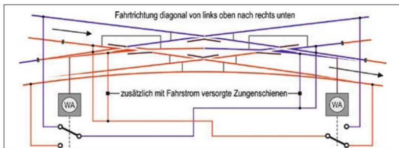
Im Stromlaufplan der EKW II wird die Fahrstromversorgung beim eingestellten Fahrweg ersichtlich.
