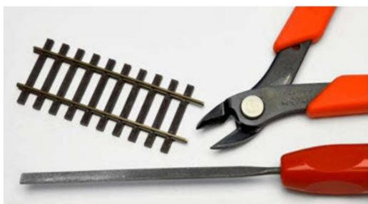
Zum Trennen der Schienenprofile ist dieser Seitenschneider aus amerikanischer Fertigung ein optimales Werkzeug. Die Feile dient zum Entfernen von Graten und zur abschliessenden Bearbeitung.
