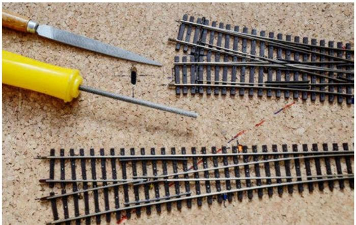
Ein Langloch für den Stelldraht ist die bessere Variante als ein grosses Rundloch, um das Durchfallen von Schotterkörnchen auf den Weichenantrieb beim Einschottern zu minimieren. Mit einem 4 oder 5 mm starken Holzbohrer werden drei Löcher gebohrt. Das mittlere nach beiden Seiten und den Schlitz anschliessend mit einer Rundfeile begradigen und von Spänen an der Unterseite befreien.
