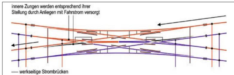
Zur Sicherheit im Fahrbetrieb werden die beiden Zungen, die den Fahrstrom durch das Anliegen weiterleiten, zusätzlich versorgt.
