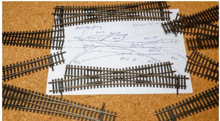
**Vor der Montage werden die Weichen probehalber nach der erstellten Skizze zusammengesteckt. Daraus ergibt sich deren Lage in Bezug auf die im Untergrund verlaufende Strecke.**
