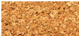
Korkplatten mit grober Struktur, wie sie in Baumärkten angeboten werden, sind als Gleisunterlage weniger geeignet
