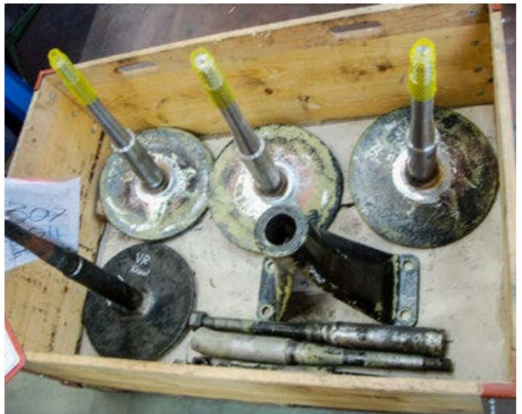
Drei der vier Puffer waren verbogen und mussten runderneuert werden.
