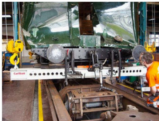
In der Werkstätte wird der Dampftriebwagen zuerst ausgeacht.
