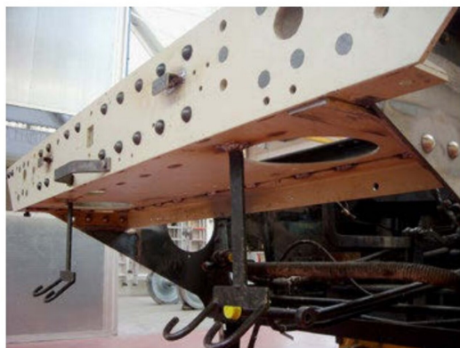
Durch die Stauchung mussten viele Teile am Rahmen ersetzt werden, was ...
