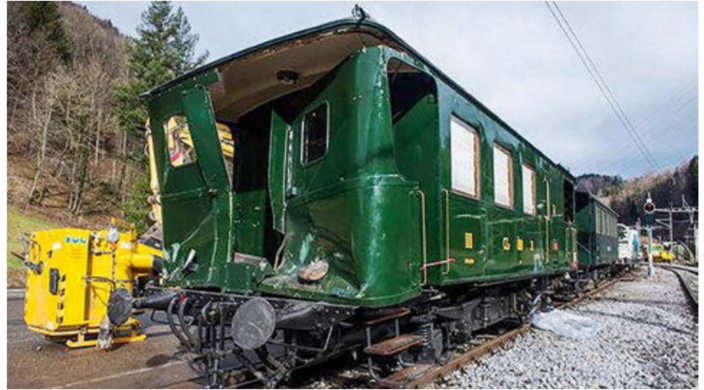
Der nach dem Unfall in Sihlwald abgestellte Dampftriebwagen zeigt die Schäden an der Kastenstruktur.
