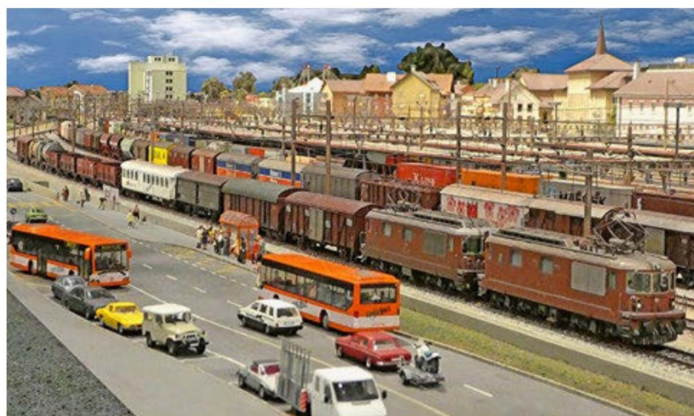
Triebfahrzeuge: 2 × Re 4/4, 160 t, 9,96 MW, Last: 28 Achsen, 480 t, V max. 90 km/h.
