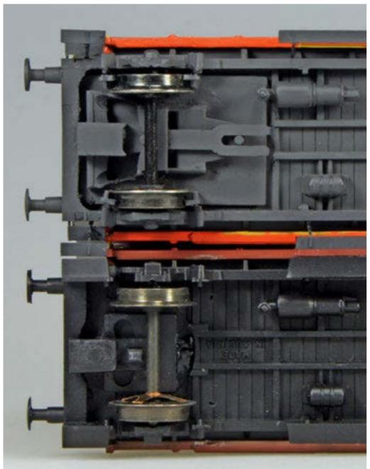
Ein Blick auf die Unterseite zeigt die KKK-Vorrichtungen von Aku-Modelleisenbahnen (unten) und die neu eingebaute von Roco (oben).
