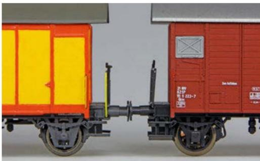
Die Nahaufnahme zeigt die geänderten Achslager, Treppenaufstiege und das filigranere Bühnengeländer. Sogar das Untergestell erhielt eine Beschriftung.
