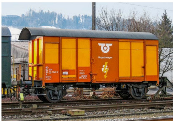
Der Bruder des umgebauten Wagens: der baugleiche Magazinwagen X 40 62 94 13 180-9 in Oberburg. Im Gegensatz zum porträtierten Umbauwagen besitzt dieser keine Speichenradsätze.
