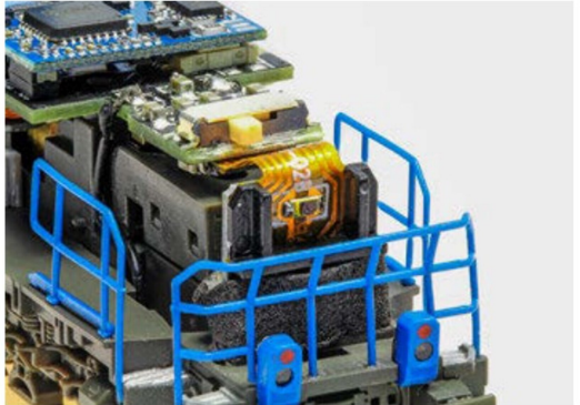
Die LED für das obere Spitzenlicht (ca. Bildmitte) mit Filzstift geschwärzt.
