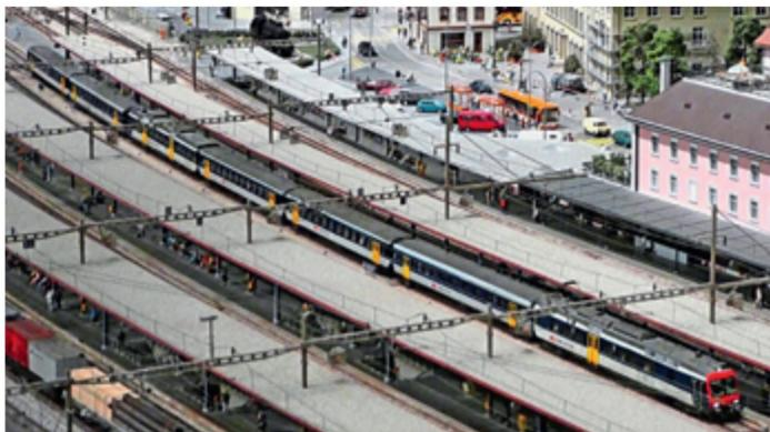
RBDe 560, 73 t, 1,65 kW, Last: 24 Achsen, 210 t, Total 491 Plätze, V max. 100 km/h.
