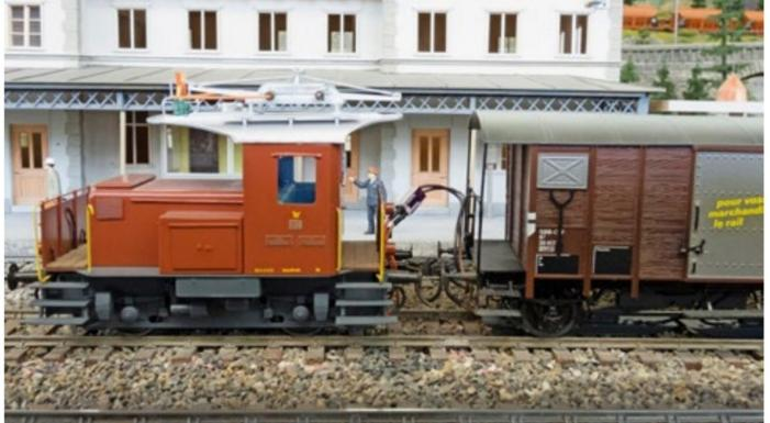
Verfügt eine Lok nicht über einen Schleifer zu Stromabnahme, kann ein «Schleifer-Wagen» aushelfen.
