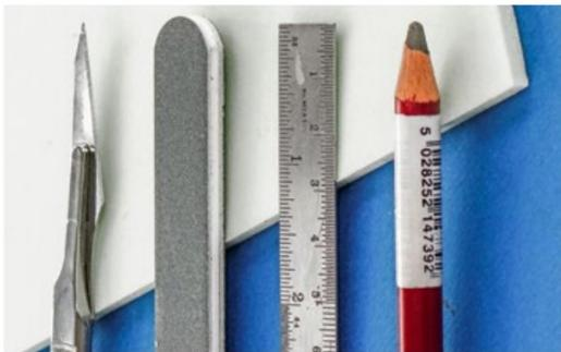
Für den Bau des kleinen Lagerhauses sind nur wenige Werkzeuge erforderlich. Ein scharfes Skalpell, mit dem sowohl Styrodur wie auch Polystyrol gut geschnitten werden kann. Eine Nagelfeile wie sie in Nagelstudios verwendet wird. Ein Stahllineal ist als Schneideschiene und zum Messen gleichermaßen geeignet. Ein paar Pastellkreiden für die Alterung und natürlich Klebstoffe und Acrylfarbe.
