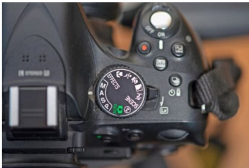
Kameraeinstellung auf «A» für «Blendenpriorität».
