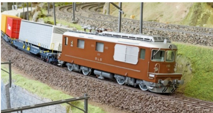
Grossen Wert haben die Erbauer der Spur-0-Anlage auf eine ordentliche Kurvenüberhöhung gelegt.
