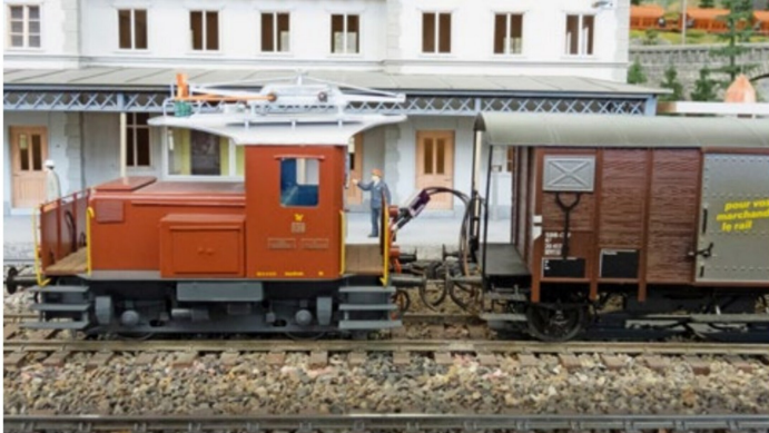
Verfügt eine Lok nicht über einen Schleifer zu Stromabnahme, kann ein «Schleifer-Wagen» aushelfen.
