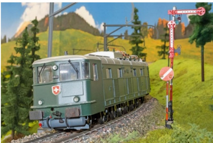
Grossen Wert haben die Erbauer der Spur-0-Anlage auf eine ordentliche Kurvenüberhöhung gelegt.
