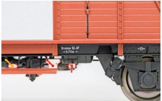
Die Hebel für Bremsartumsteller, Lastwechsel und Absperrhahn.
