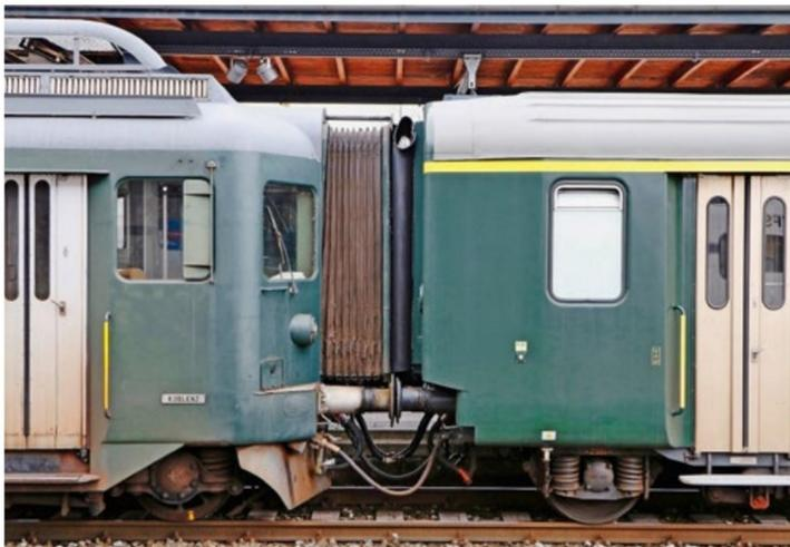
Nettes Detail: der Faltenbalg des BDe 4/4 1641 verbunden mit dem Gummiwulst des A 524.
