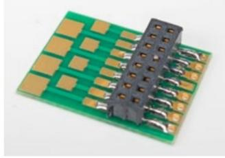
Adapterplatte von AMW mit den Löt pads.
