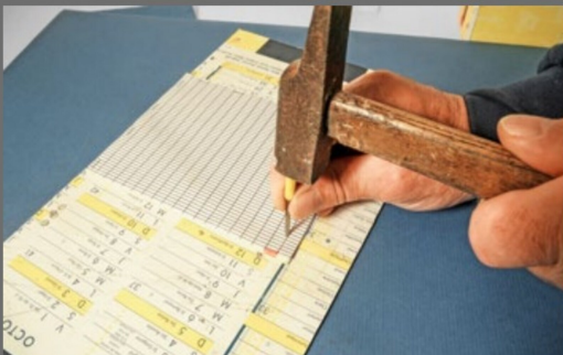
... ein Stanzwerkzeug zur Herstellung von Biberschwanzziegeln aus Papier.
