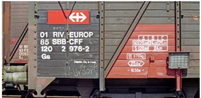
Detail eines Anschriftfeldes mit Wagenidentität und technischen Daten. Aufnahme aus dem Jahr 1994.
