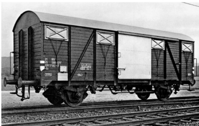
Die auffälligen Aluminiumschiebetüren waren das «Markenzeichen» der SBB-Wagen.
